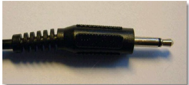
Dieser Stecker hat nur einen Isolierring. Es handelt sich also um einen Mono-Stecker, welcher ungeeignet ist.
