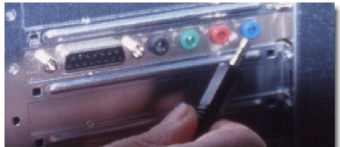
Der Line In am Computer ist normalerweise farblich codiert. Blau ist Line-In, Rot ist der Mikrofon-Eingang.
