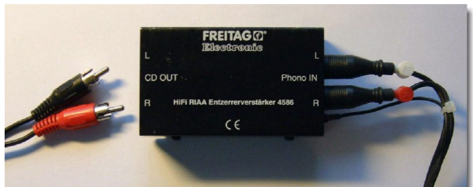
Ein Entzerr-Vorverstärker der Marke Freitag, Artikelnummer 4586, erhältlich in allen HiFi-Abteilungen großer Elektromärkte. Rechts wird der Plattenspieler angeschlossen, links geht's zum Line In des Computers.
